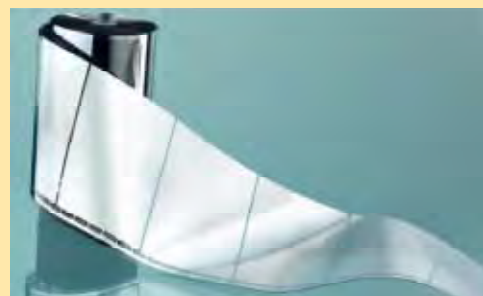
金属腹膜采用分割胶片式结构保证自愈功能
